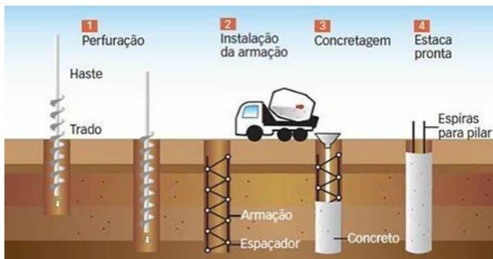
Figura B-6: Fundação tipo estaca
